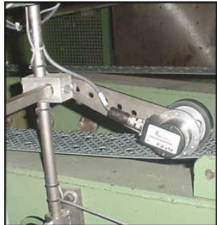
Rad-gefahrne Kodierer- und Haltewinkel-Einfassung - Beispiel
