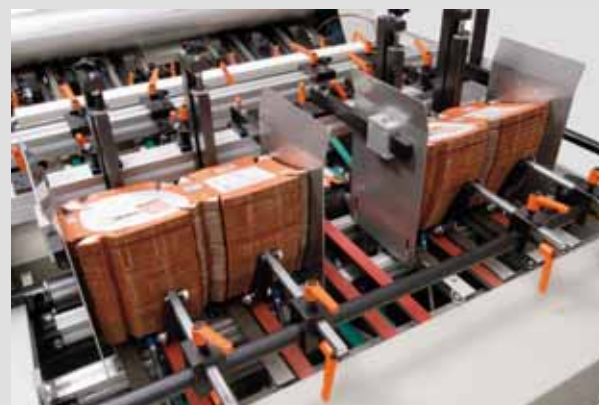
Beschildert wird die Maschine durch einen getakteten Reibriemen-Anleger. Für empfindliche oder schwierig zu trennende Zuschnitte empfiehlt sich die zusätzliche Vakuum- Saugvorrichtung (*). Eine Sonderausführung dieses Anlegers ermöglicht Zuschnitte unterschiedlicher Länge gleichzeitig einzuziehen (*).
