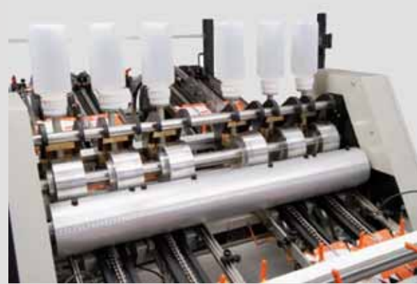
Kaltleim wird mit Schaumstoff-Stempeln aufgetragen. Die Befestigung der Stempel kann auf einer Stahltrommel oder separaten Rädern vorgenommen werden (wählbar bei Bestellung).
