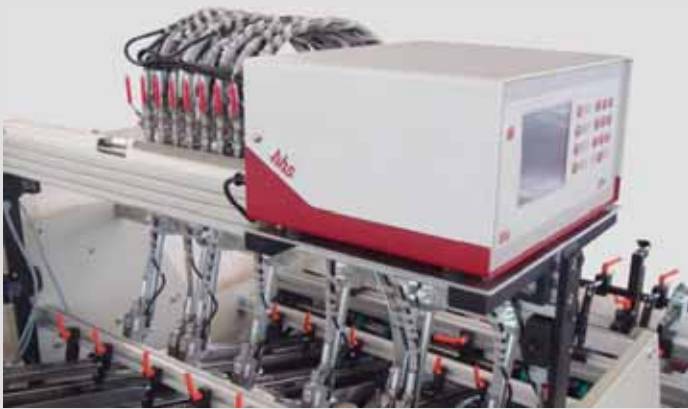
Kaltleimauftragung über ein Sprühsystem welches die übliche Waschprozedur erübrigt (*). Auf Wunsch auch lieferbar mit Heissleim-System (*).
