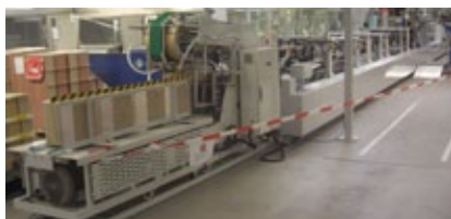
Flamförseglare > 650 m/min från Gluertech, USA
